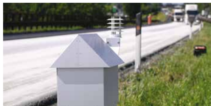
3. Le concentrazioni di IPA nell'aria ambiente misurate in prossimità dei cantieri sono risultate inferiori ai limiti normativi italiani
