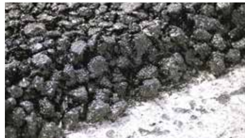
4. L'impiego di materiali riciclati consente un risparmio di materie prime vergini, mentre la riduzione delle temperature di produzione e messa in opera limita le emissioni ambientali durante le operazioni
