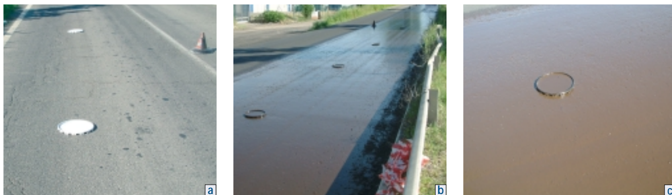
FIG. 4 Test dei vassoi: posa dei vassoi, superficie di stesa bagnata di emulsione e vassoio bagnato
