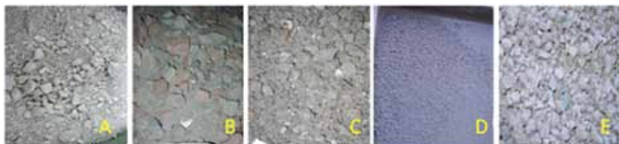
Figura 1 - Materiali della sperimentazione: A. Frantumato di cls, B. Misto Riciclato da C&D, C. Scarto proveniente da processi termici di fusione dei metalli, D. ed E. Scarti provenienti da processi di termovalorizzazione di rifiuti solidi urbani
